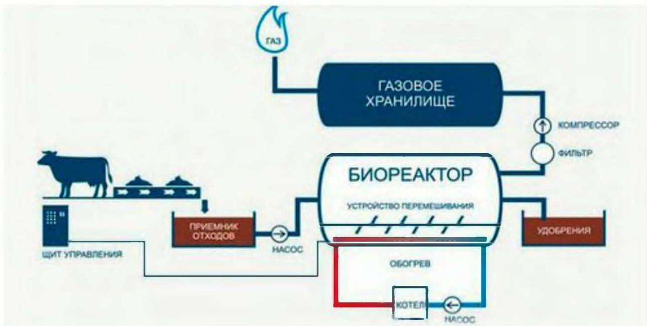
Рисунок 6. Примерная схема получения биогаза из навоза (помета).
