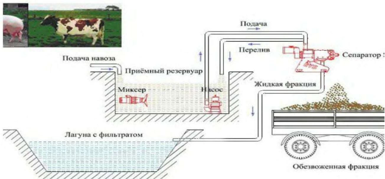
Рисунок 5. Примерная схема сепарации побочных продуктов животноводства.
