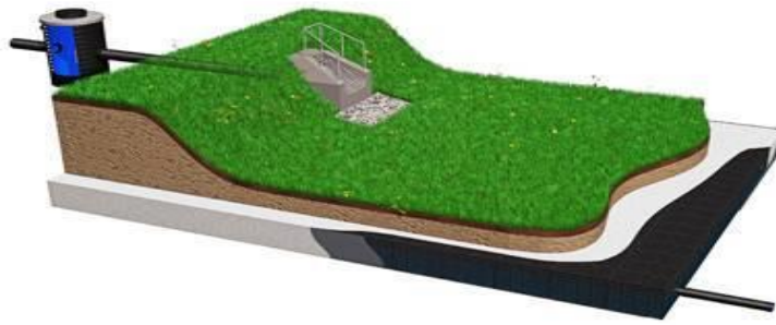
Рисунок 1 – Схема устройства бассейна удержания
