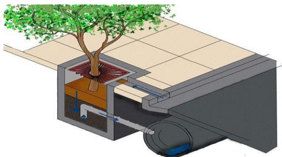
Рисунок 36 – Схема устройства коробчатых фильтров с посадкой деревьев
